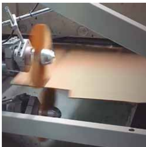
Il sistema ERO-ETR, che rimuove sfridi e scarti dalle scatole prima del processo di incollaggio, è anche facile da installare e gestire / Easy to install and control, ERO-ETR removes trim and scrap from boxes before the gluing process
